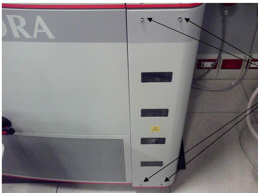
Per accedere al vano contenente la protezione di interfaccia rimuovere le 4 viti del carter
